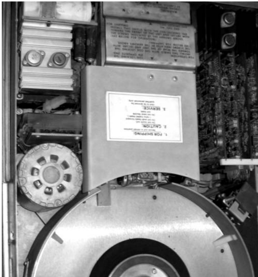
Илл. 15: Жесткий диск. Вид сверху со снятыми металлическими кожухами.
