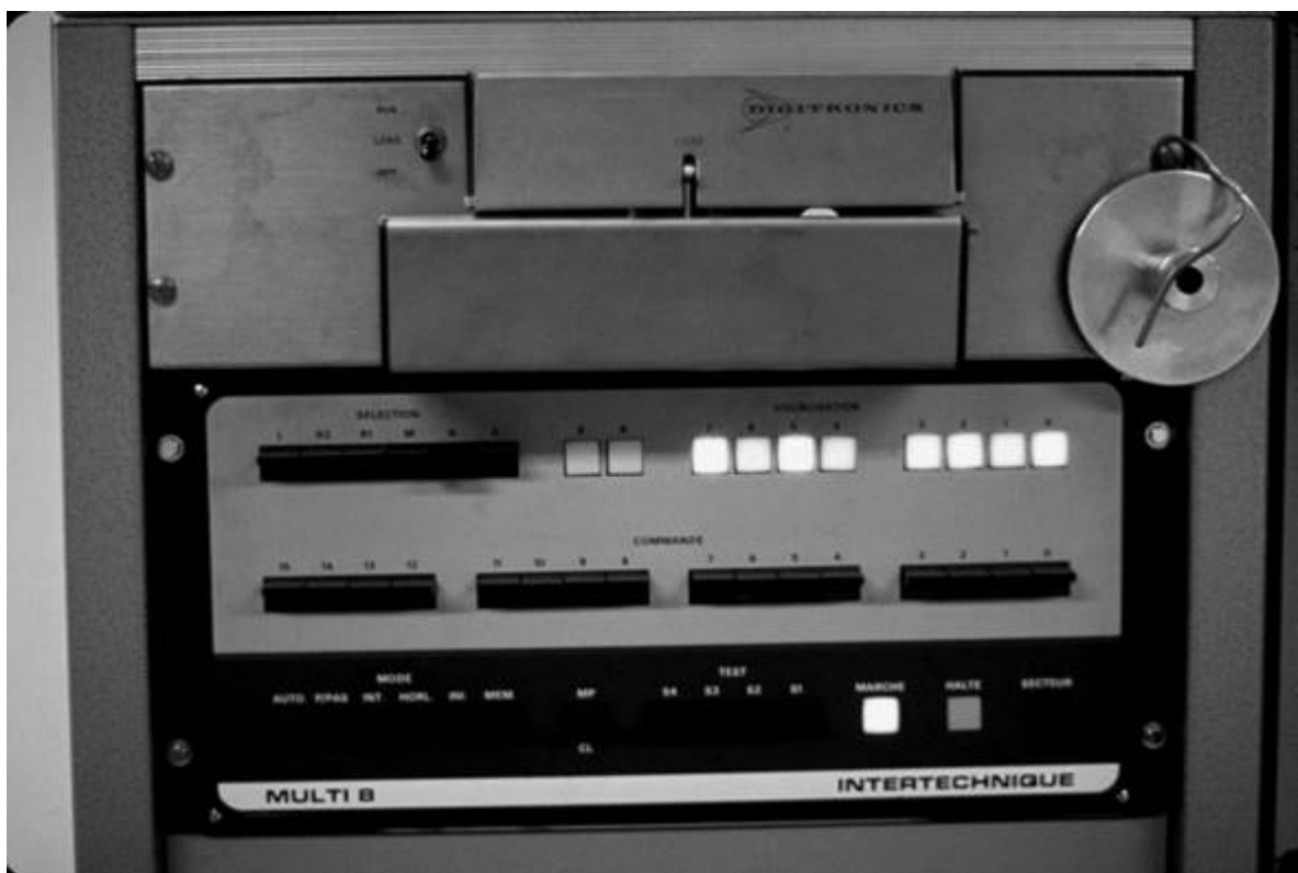
Илл. 25: Оптический привод для чтения перфоленты (Digitronics).
