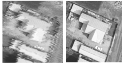
Рис. 5. Исходное изображение (слева), полученное трёхканальным сканирующим аэросенсором, и ректифицированное изображение (справа)
