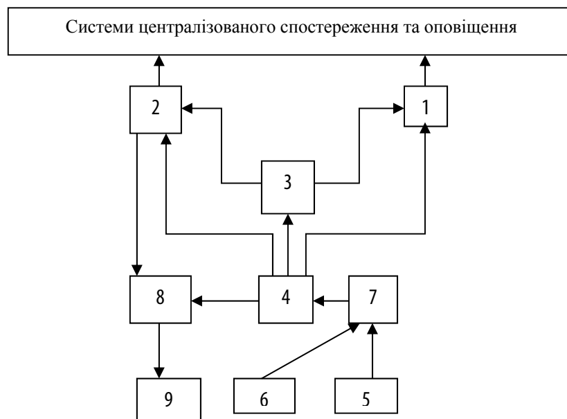
Рис. 2. Структурна схема інтелектуальної системи сповіщення
