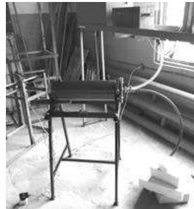
Рис. 2. Схема стенду для випробування ТА без циркуляції 1 – теплоакумулятор; 2 – смінь з рідиною; 3 – кран; 4, 6 – трубопроводи; 5 – електричний нагрівач; 7 – смінь з нагрітою рідиною
