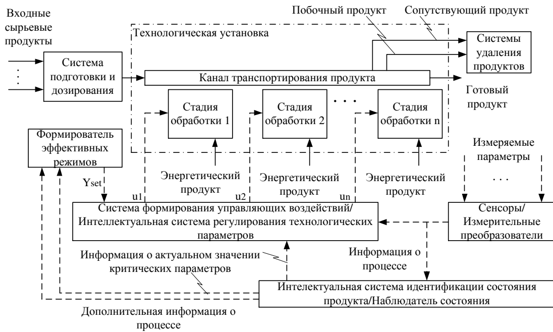
Рис. 2. Общая структура интеллектуальной производственной системы
