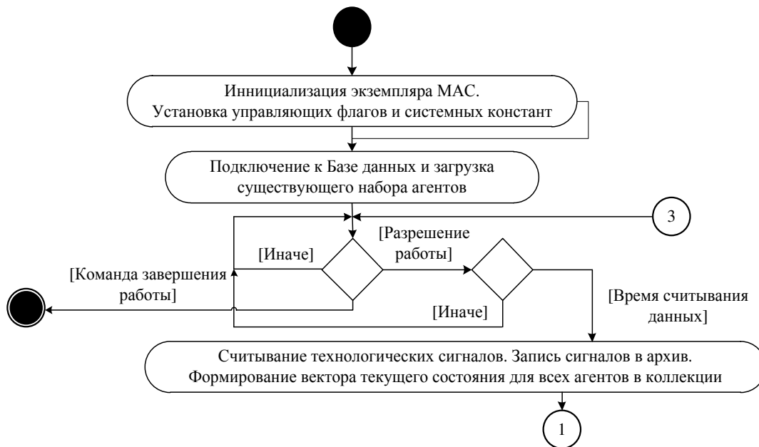
Рис. 5. UML-диаграмма активности мультиагентного регулятора
