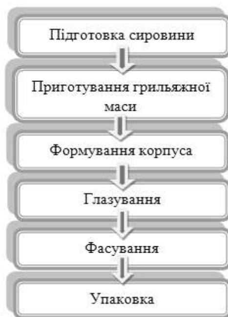
Рис. 1. Блок-схема виробництва грильязу «Південного» безперервним способом
