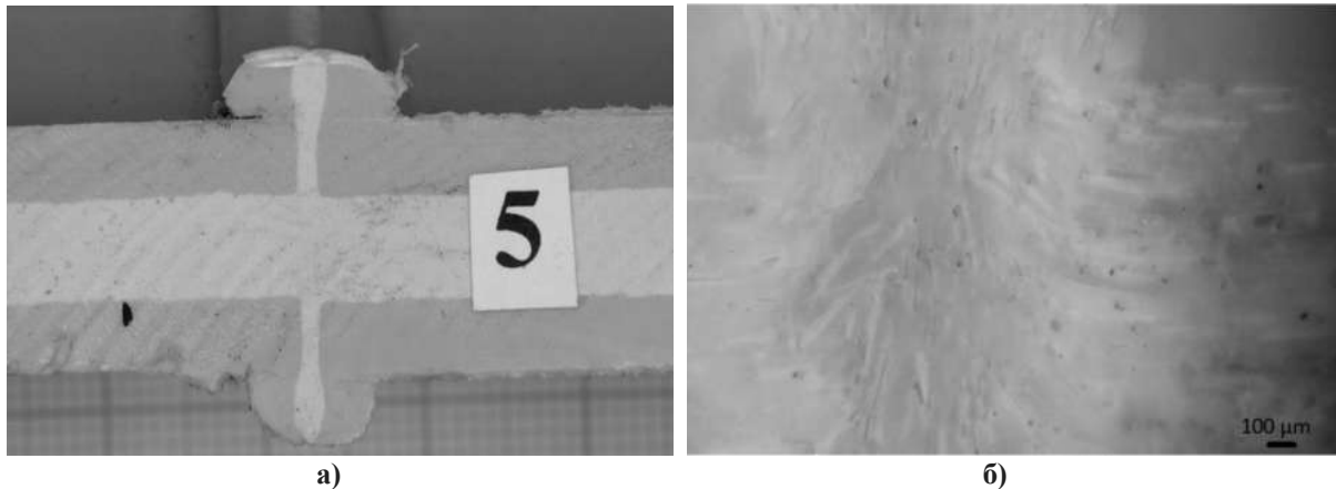
Рис. 4. Стиковий зварний шов тришарових поліпропіленових композитних труб (а) та його мікрофотографія (б), отримана за допомогою рефлексійної оптичної мікроскопії
