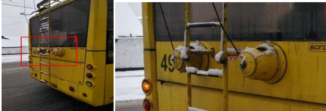
Рис.3. Механізми, що опускають штанги «Богдан Т70117»
