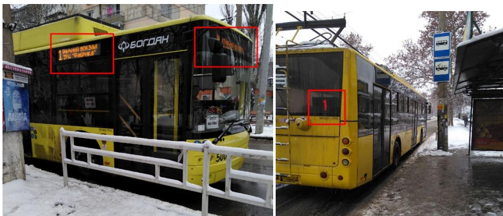
Рис.2. Електронні дисплеї тролейбусів «Богдан Т70117»
